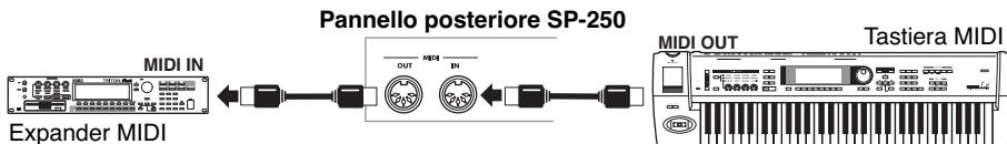
Per collegare SP-250 ad un computer, occorrono un'interfaccia MIDI per il computer, un software di sequencing o notazione musicale, e due cavi MIDI standard. Col-
