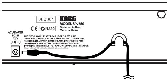
Una volta collegato l'alimentatore e il cavo di alimentazione, premete l'interruttore POWER per accendere lo strumento. Quando lo strumento è acceso, gli indicatori luminosi del pannello di controllo sono accesi. Per spegnere lo strumento premete nuovamente l'interruttore POWER.
