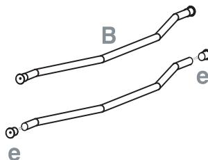
5 Unite la barra pedale (B) e le gambe (A'), assicurandovi che la parte convessa punti verso il retro del supporto (come mostrato in figura). Fissatele con le due viti lunghe (a).
