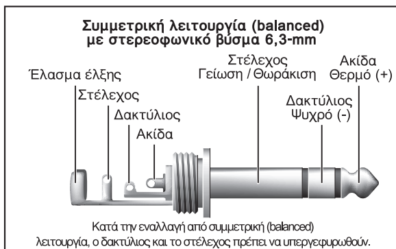
Εικ. 4.2: Στερεοφωνική υποδοχή βύσματος 6,3 mm
