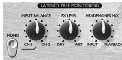
La sección LATENCY FREE MONITORING se utiliza conjuntamente con la sección MONITOR LEVELS que proveen una monitorización flexible tanto de la señal que se está grabando como de una mezcla ya existente.
