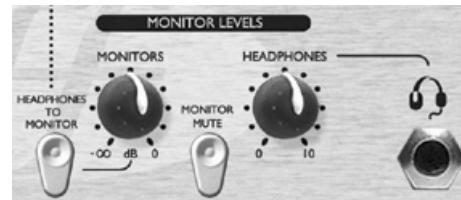
**MONITORS (Regler)** – Erlaubt unabhängige Kontrolle über den Signal-Pegel der zur externen Abhöre geht.
