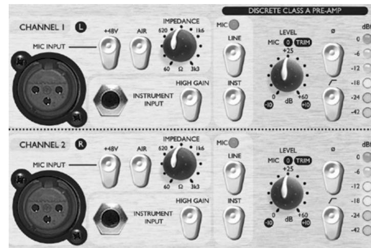
**IMPEDANCE (Regler)** – Drehen des IMPEDANCE-Reglers ändert die Eingangsimpedanz des Mikrofonvorverstärkers (nur für den MIC INPUT wirksam). Die Einstellung der Impedanz des Class-A Vorverstärkers des TwinTrak Pro ermöglicht eine Abstimmung des PreAmps und des angeschlossenen Mikrofones bezüglich Pegel und Frequenzverlauf. Weitere Informationen siehe MIC PRE-AMP EINGANGSIMPEDANZ auf Seite 25.
