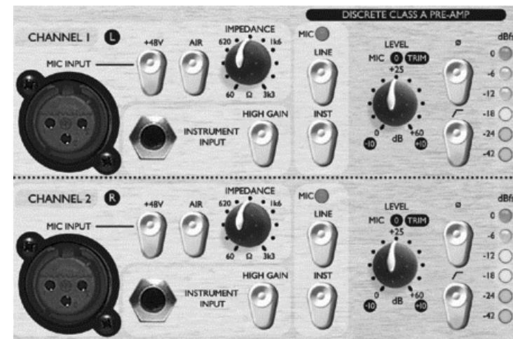
**INSTRUMENT INPUT** – Son entradas jack “ ” de alta impedancia que permiten la conexión de guitarras o bajos eléctricos a la unidad sin cargar los pickups, y sin necesidad de DI box.
