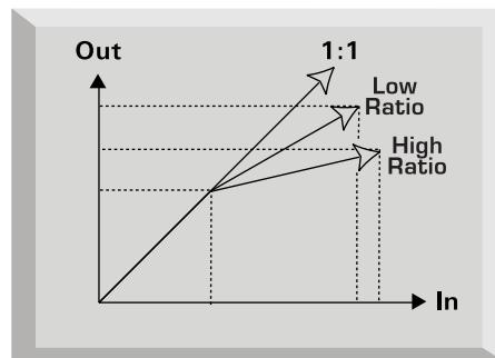
Lassen Sie uns zu einem Beispiel mit reellen Werten übergehen: Wenn der Threshold auf -10dB und die Ratio auf 4:1 eingestellt ist wird jedes Signal, welches -10dB überschreitet, am Ausgang des Kompressors nur um 1dB lauter, wenn es eingangsseitig um 4dB steigt. Also wird ein Eingangssignal mit einem Peak von -6dB (= 4dB über dem Threshold) zu einem Ausgangssignal mit einem Peak von -9dB (= 1 dB über dem Threshold). Signale mit einem Pegel unterhalb des Thresholds bleiben
