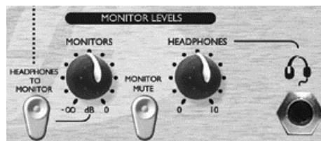
**HEADPHONES TO MONITOR (commutation du circuit casque vers le circuit d'écoute externe)** – Permet d'adresser le mix du circuit casque (déterminé par le bouton HEADPHONE MIX) vers le circuit des écoutes externes contrôlé par le bouton MONITOR LEVEL. Cela permet de créer un mix au casque et de l'écouter sur les enceintes en gardant un contrôle indépendant sur le niveau d'écoute casque.
