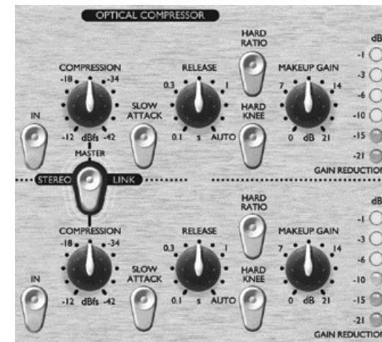
**IN (tasto)** – Inserisce il COMPRESSORE OTTICO nel percorso del segnale. Il LED rosso del tasto si illumina quando premuto.
