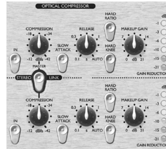
**SLOW ATTACK (Schalter)** – Wenn er eingeschaltet ist, reagiert der Kompressor in der Ansprache (Attack) langsamer, so daß mehr Transienten (Einschwingphase des Signales) den Kompressor passieren. Dies kann hilfreich sein, bei starker Kompression den ursprünglichen Charakter des Signales beizubehalten. Beispielsweise kann so eine Snare Drum stark komprimiert werden, ohne den Anschlag des Sticks auf das Fell zu verlieren.
