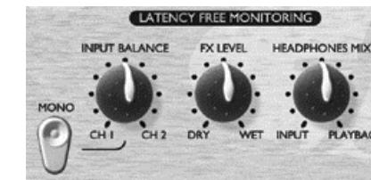
La section LATENCY-FREE MONITORING du TwinTrak Pro vous permet d'écouter un mix du signal mono ou stéréo à enregistrer (avant qu'ils ne passent dans le système d'enregistrement) et d'une réduction stéréo du signal déjà enregistré (fonctionnant comme une mini-console). Le temps de latence est donc éliminé et le musicien peut chanter ou parler sur l'enregistrement déjà réalisé en parfaite synchronisation.
