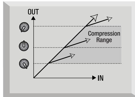
Wie stark der Kompressor die Verstärkung reduziert, wird vom Ratio-Wert bestimmt. Der Ratio-Parameter wird normalerweise als numerischer Wert, z. B. 4:1, ausgedrückt. Der Wert stellt die Stärke dar, mit der die Verstärkung verringert wird, wenn der Pegel des Signals den Schwellenwert übersteigt.
