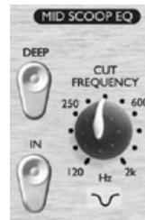
**IN (Schalter)** – Schaltet den MID SCOOP EQ in den Signalpfad. Eine rote LED leuchtet bei aktiviertem Schalter.
