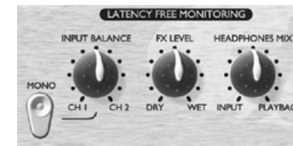
Die latenzfreie Monitor-Sektion des TwinTrak Pro ermöglicht ein Abhören der Signale, bevor diese zum Aufnahmemedium geschickt werden – zusammen mit dem Stereomix bereits aufgenommener Spuren (wie ein Mini-Mixer). Dadurch ist eine Aufnahme von neuen Tracks „in time“ zu bereits vorhandenen problemlos möglich.
