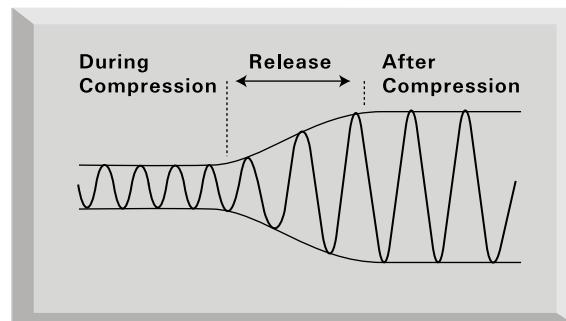
Bei kurzen Release-Zeiten lässt der Kompressor das Signal sehr schnell zu seinem normalen Pegel zurückkehren. Dadurch wird manchmal ein „pumpender“ Klang erzeugt, bei dem die Lautstärkeänderungen deutlich hörbar sind. Abhängig vom Musikstil kann dies unerwünscht sein oder als nützlicher kreativer Effekt verwendet werden.
