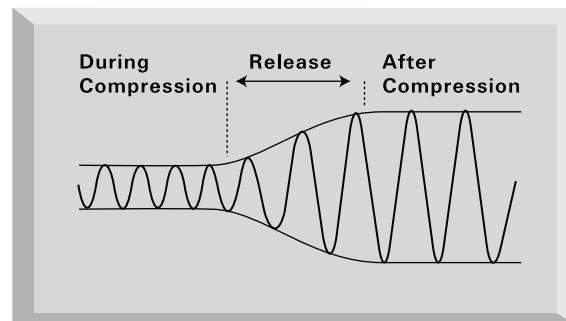
Un tiempo corto de release significará que el compresor devolverá la señal rápidamente a su volumen original. Puede producir un sonido "pumping", donde los cambios de volumen son muy audibles. Dependiendo del estilo de música, podría ser no deseable, o bien útil para crear un efecto.
