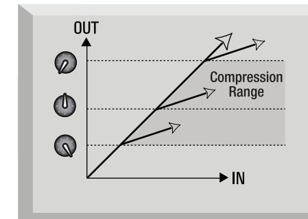
La quantité de réduction de gain appliquée par le compresseur est appelée “Taux” (Ratio en anglais). Le taux est exprimé sous forme de rapport : 4:1, par exemple, qui représente la réduction de gain appliquée lorsque le niveau du signal dépasse le seuil.
