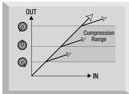
La cantidad por la que el compresor reducirá la ganancia se determina mediante el "ratio". El ratio se determina convencionalmente con un valor numérico, p. e. "4:1", que representa la cantidad a la cual se reduce la ganancia cuando la señal supera el threshold.
