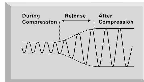
Le rétablissement détermine le temps que met le compresseur à cesser de traiter le signal une fois que son niveau est repassé en dessous du seuil. Un temps de rétablissement court signifie que le compresseur rétablit rapidement le signal à son niveau initial. Ceci peut entraîner des effets de "pompage", lorsque les variations de niveau deviennent audibles. Selon le type de musique, cet effet peut être souhaitable, ou utilisé comme instrument créatif.
